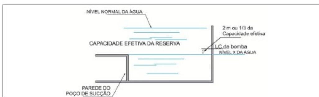
Figura C.1: Condição positiva de sucção da bomba de incêndio
